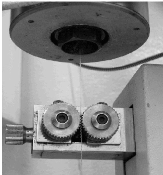
Fig. 1. Melt strength test – Goettfert RheoTester 1000.
