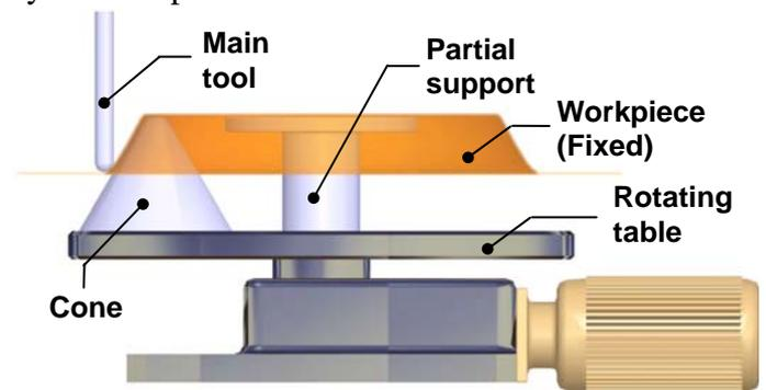
Fig. 2: Experimental setup – Dyna-Die
